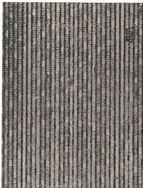
Figuur 10. Een zichtbaar gemaakte registratie van een 250 kHz signaal (5 x vergroot detail).
